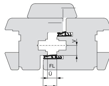
Mögliche Werte für Falzlufft, Falztiefe, Versatz und Überschlag: FL = Falzlufft: 4 oder 12 mm; V = Versatz: 9 oder 13 mm
